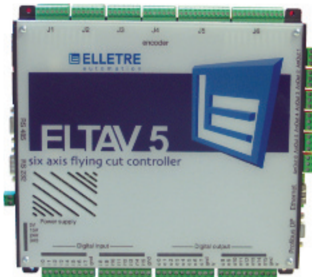
FIG|04 | Eltav 5, il controllore per il taglio al volo di tubi e profilati.
