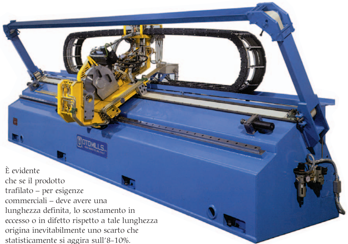
Fig. 3 Modernissimo gruppo per taglio volante di fabbricazione Oto Mills (gruppo Marcegaglia) destinato a equipaggiare le linee di produzione del tubo saldato.
