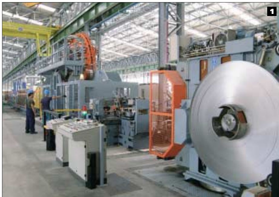
Fig. 1 - Linea in HF per produzione tubi saldati inox.
